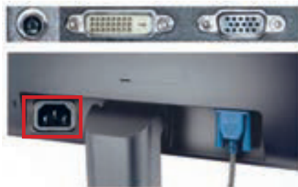
شکل ۴- محل اتصال کابل‌های صفحه نمایش
